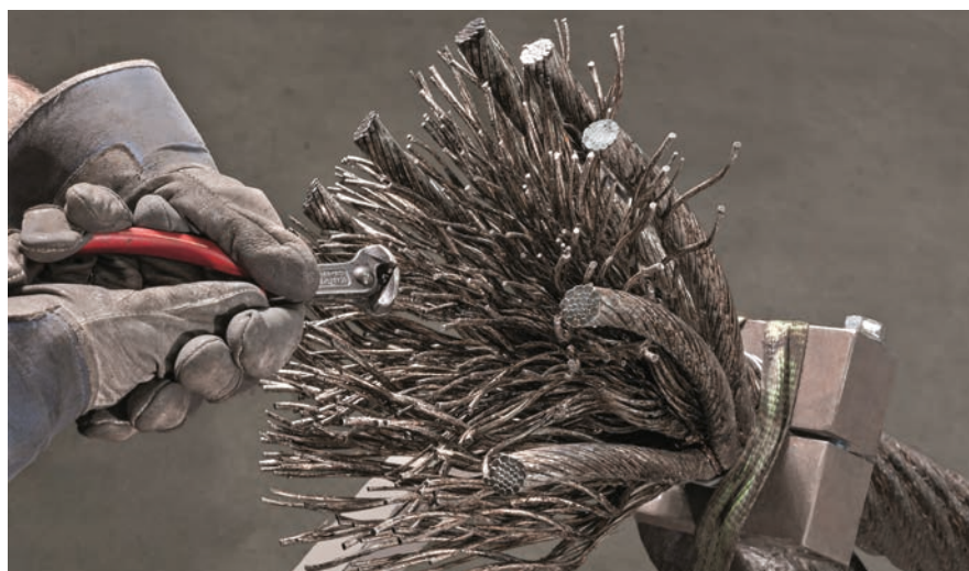
Seilkonfektion: Im Stammwerk in Memmingen werden Seile zugeschnitten und mit passenden Seilendverbindungen bestückt.
